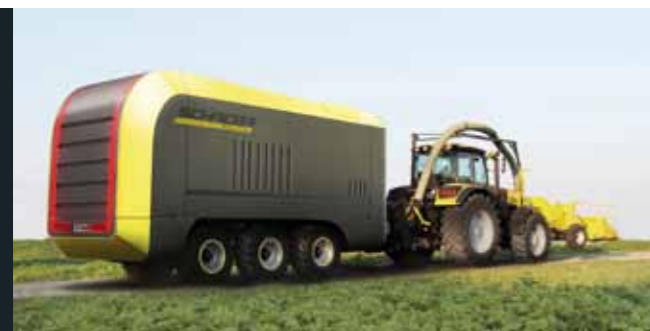
Die mobile Erntemaschine Schaidler Pelletec D 8.0 Direkt am Feld in einem Arbeitsgang bis zu 8 t gebrauchsfertige Pellets pro Stunde.
